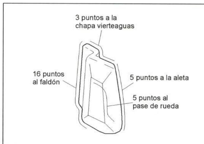
**Figura 41.** - Unión de la chapa portapiloto
