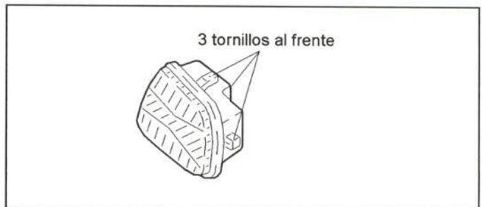
Figura 15.- Unión del faro delantero
