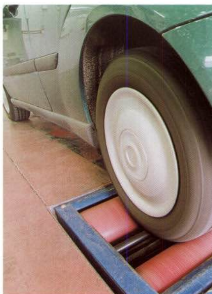
Ensayo de la capacidad de frenado
