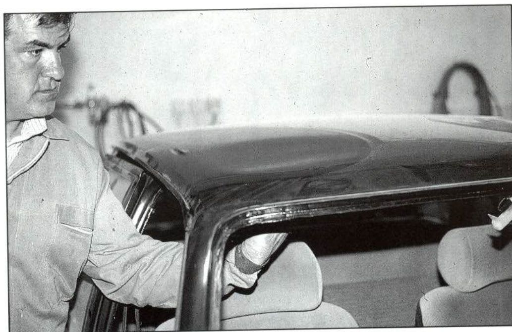
FIGURA 1.—Abolladura amplia en un techo.
