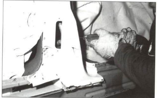
Una vez retirado el pie del pilar, se podrá acceder al desgrapado de dichos puntos de soldadura, pudiendo retirar el resto del estribo que ha quedado oculto debajo del pilar.
