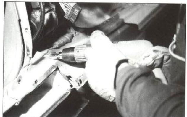
Una vez colocado el estribo, habrá que devolver los dos puntos que lo unen al cierre del pilar central; en este caso, mediante la técnica de soldadura MIG a tapón, debido a la imposibilidad de acceder a la zona con la punteadora por puntos de resistencia.
