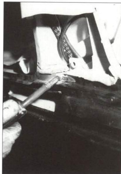
Finalmente, se volverá a colocar el pie del pilar, soldándose con puntos de resistencia a su cierre en los extremos, soldadura MIG en cordón continuo en su parte superior y MIG a tapón en la parte inferior de unión al estribo.
