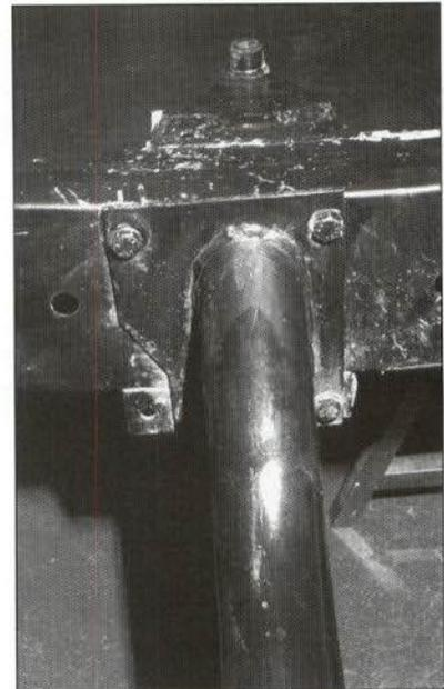
Figura 6.-Detalle de traviesa unida por tornillos.
