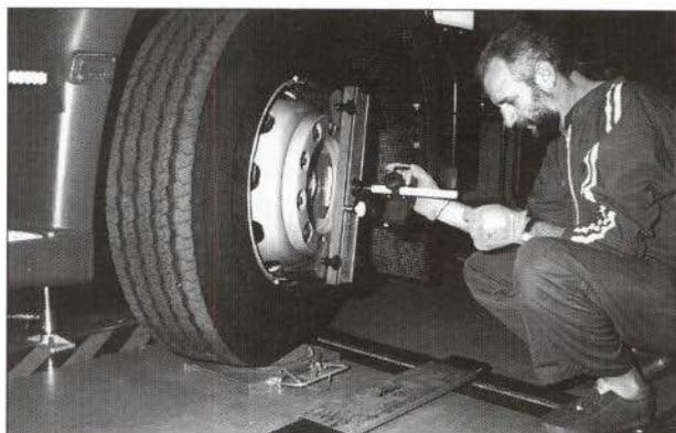
Figura 10.—Medición de la divergencia con ángulo de  $20^\circ$ .
