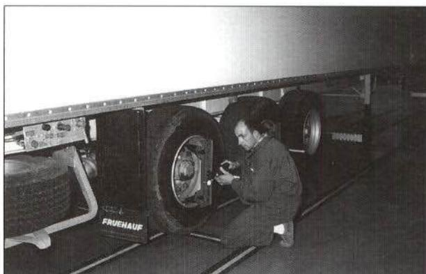
Figura 1.—Alineación de semirremolque.
