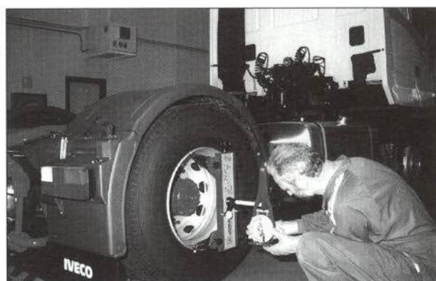
**Figura 7.**—Medición del ángulo CAMBER en las ruedas traseras.
