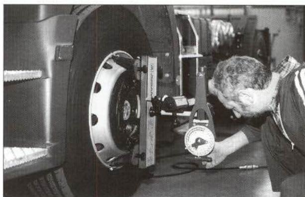
Figura 9.—Medición del ángulo de avance.
