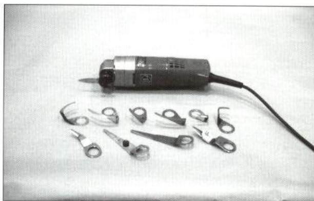
Figura 6.-Máquina de cuchillas oscilantes.
