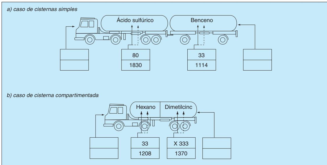
Figura 2. Paneles Naranja para cisternas que transportan varias sustancias incluidas en la tabla A del ADR/07
