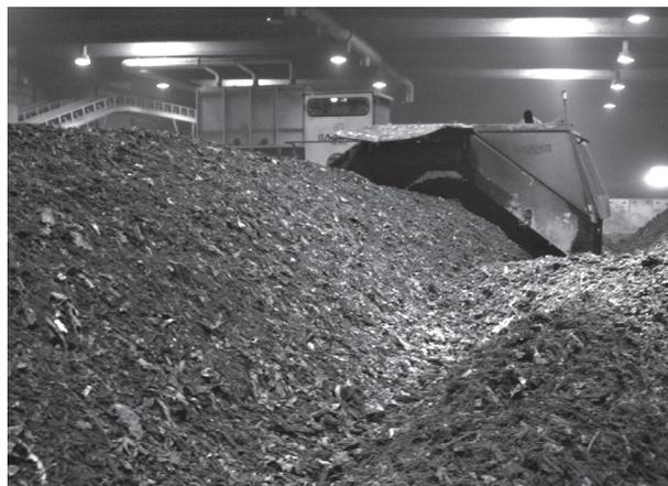
Figura 2. Volteo de las pilas mediante volteadora
