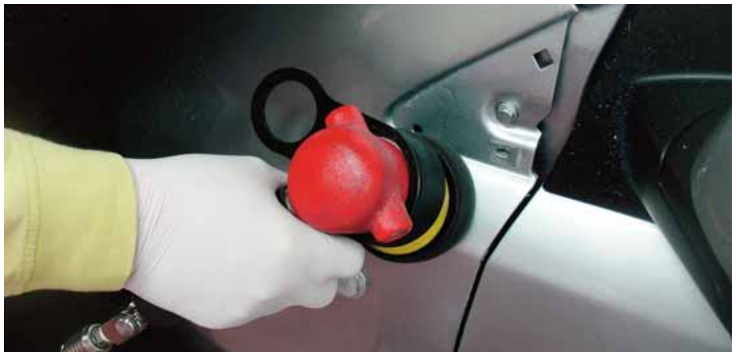
▸ Abrillantado con la boina específica
