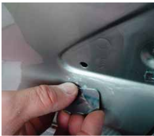
► Eliminación del descolgado del barniz con cuchilla
