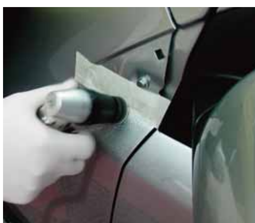
► Lijado de la gota con lijadora radial y P3000
