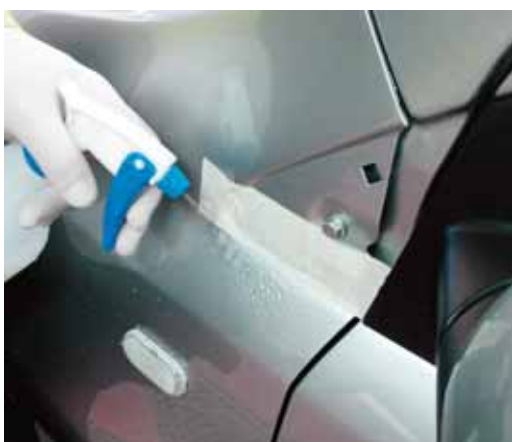
► Se humedece la zona afectada
