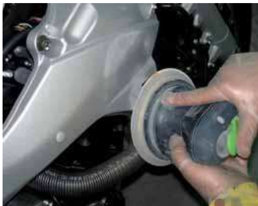
► Reparación de un daño en un chasis
