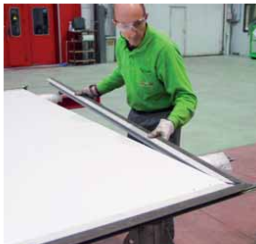
► Montaje de marcos de puerta trasera
