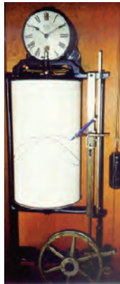
Imagen de un mareógrafo histórico / Fuente: IEO.
