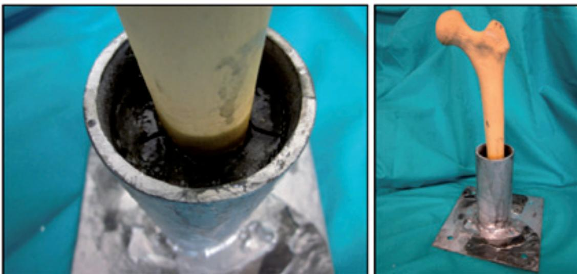
**Figura 36a.** Fotos de las bases con los fémures fijados con resina de poliéster.
