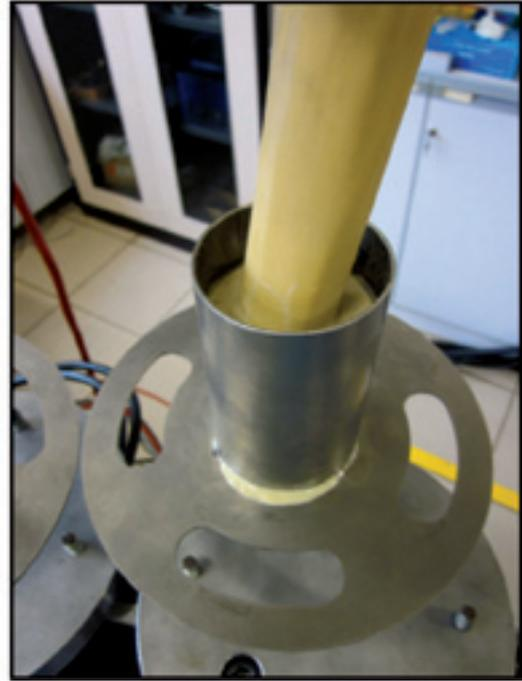
Figura 36b. Fotos de las bases y los fémures fijados con resina epóxica.
