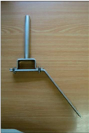
Figura 21. Foto del sistema puente-pletina con orificios laterales fabricados.
