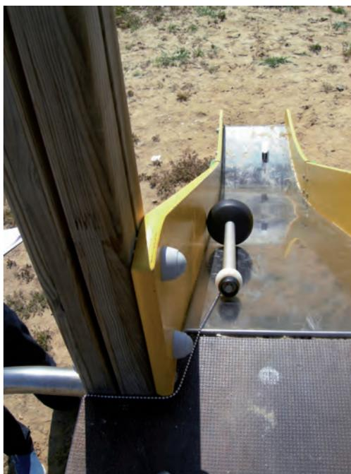
**Figura 3.** Aprisionamiento de ropa y pelo provocados cuando el usuario se encuentra en movimiento forzado.
