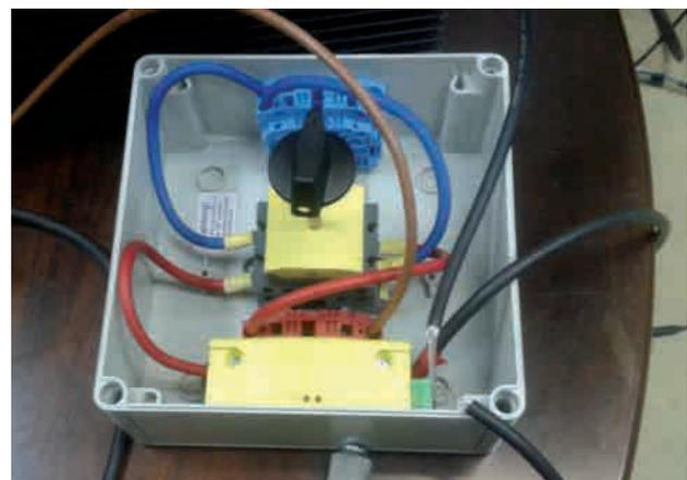
**Figura 11.** Imagen del detector de arcos ensayado ubicado en la caja de protección IP65, donde se incluye un interruptor manual de corriente continua (32A/1000V).
