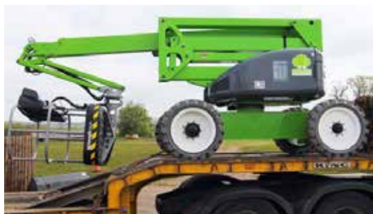
Figura 10. Amarre por rozamiento de una PEMP.
