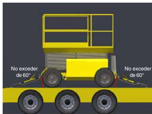
Figura 11. Tensado sobre lados opuestos de la carga.
