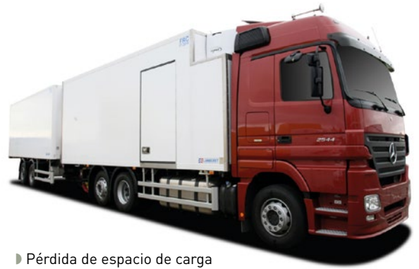
▶ Pérdida de espacio de carga en un vehículo rígido frigorífico con cabina elevada
