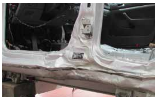
► Exterior e interior de la zona de unión entre pilar B y estribo
