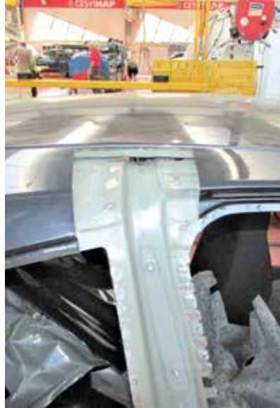
► Sustitución del pilar B mediante ventana de acceso o desmontaje del techo
