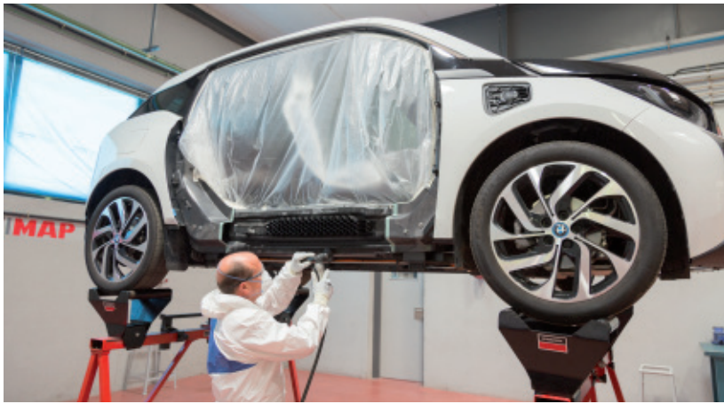
► Sustitución del estribo del BMW i3
