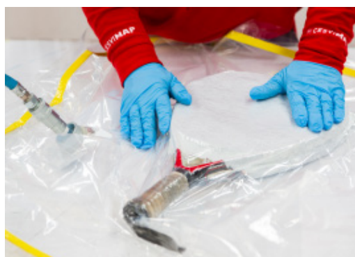
► Reparación de una raqueta de pádel
