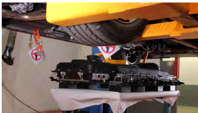
Desmontaje de la batería
