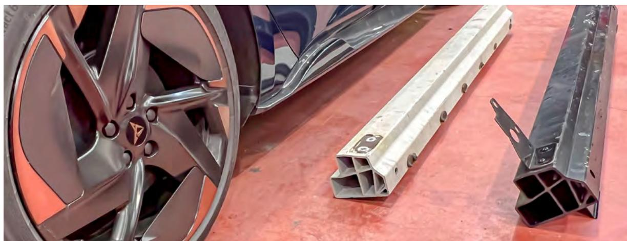
Barra de aluminio extruido para protección de batería de tracción
