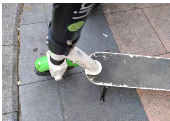
Daños habituales en patinetes eléctricos de sharing
