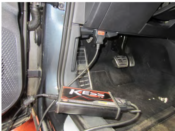
Reprogramación a través de conector OBD
