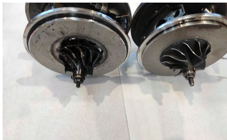
Álabes de compresor rotos (izquierda) y en buen estado (derecha).
