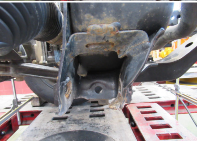
Daños en soporte de triángulo de suspensión
