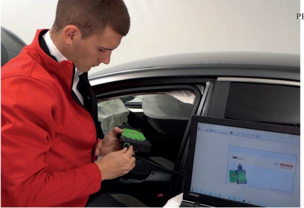
Recogida de datos del vehículo accidentado con la máquina CDR
