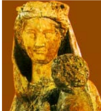
Estatua de madera desinfectada y consolidada por irradiación
