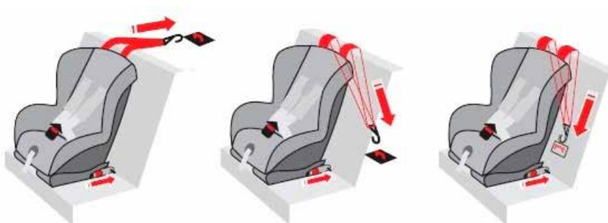
Figura 69. Ejemplo del sistema de fijación Top Tether
