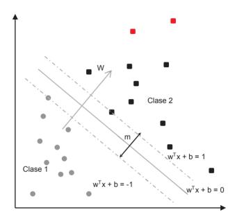
Figura 2.5. Clasificador con máquinas de soporte vectorial
