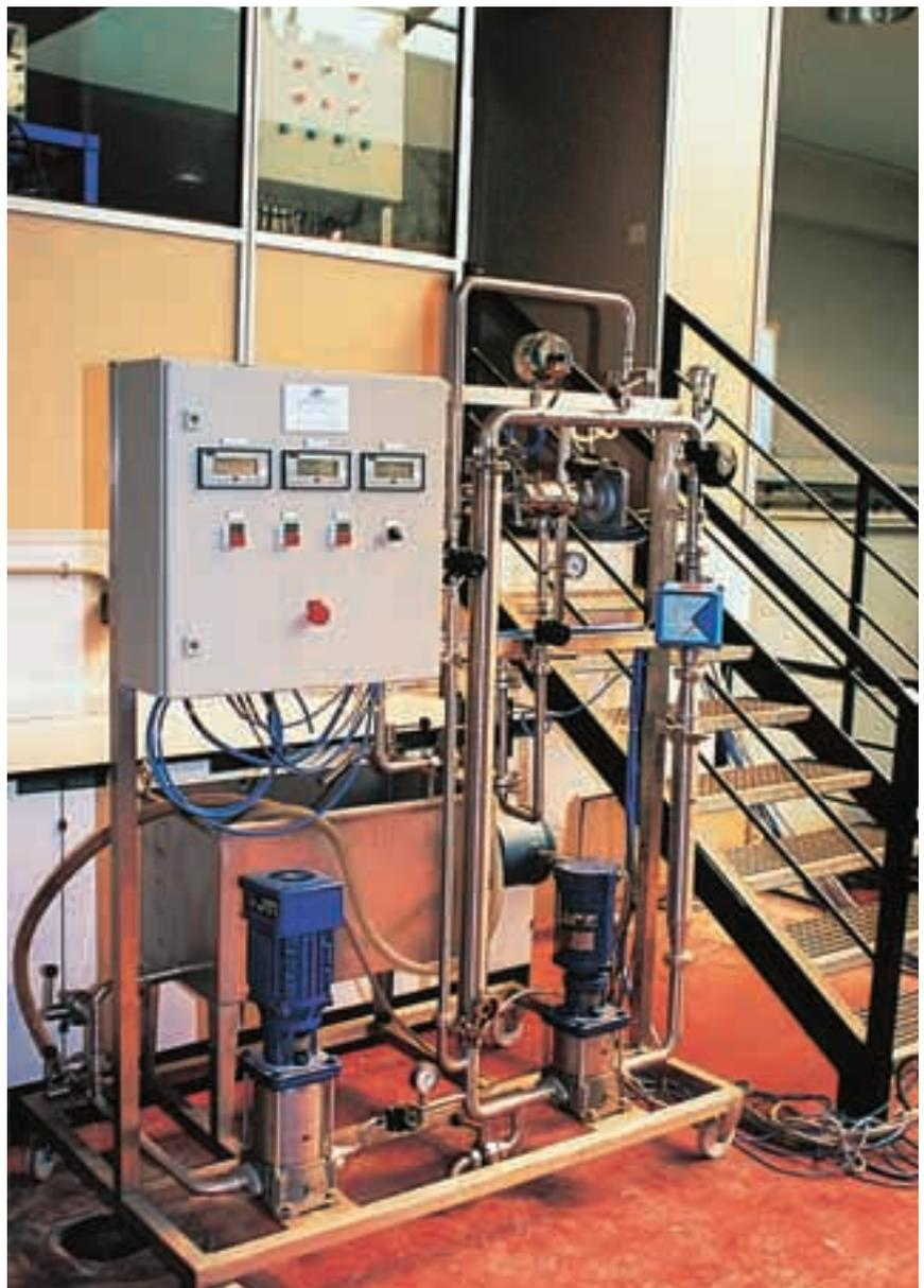
*Piloto industrial de pervaporación con membranas hidrófilas e hidrófobas.*
