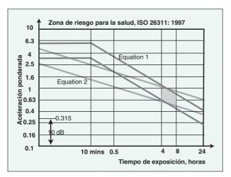
Figura 2. Zona de precaución definida en el anexo B de la Norma ISO 2631-1: 1997
