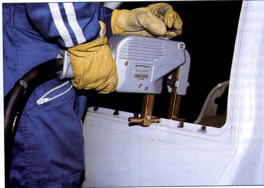
Soldadura por puntos con la pinza neumática.
