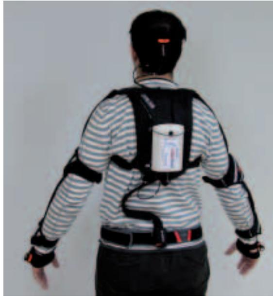
**Figura 3.** Detalle del concentrador que se comunica vía *bluetooth* con una PDA. Colocación en el cuerpo.
