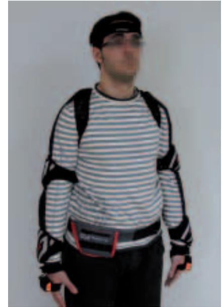
**Figura 4.** Chaqueta instrumentalizada y elementos de fijación de los sensores.
