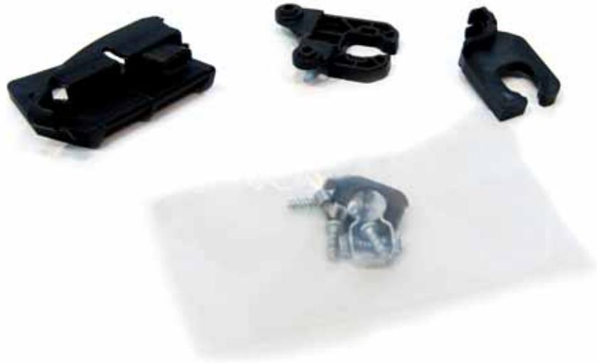
► Componentes de un kit de reparación de faros
