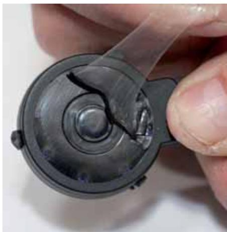
▶ Retirar el adhesivo dañado del sensor
