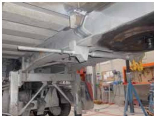
► Útil de sujeción en la placa porta *King-pin*
