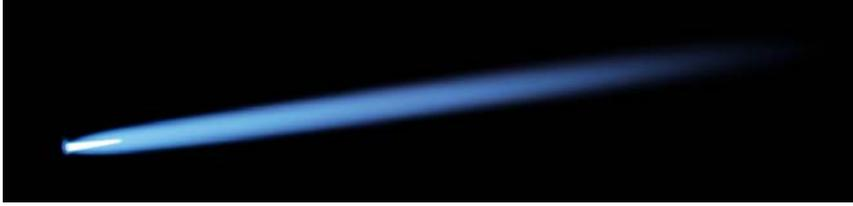
**Figura 5a.** Llama de luz emitida por un soplete. Puede apreciarse el color azul de la llama, lo que indica la emisión de grandes proporciones de longitudes de onda corta (muy energéticas y dañinas para el tejido).
