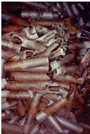
Camisas de grafito de los combustibles irradiados (Fuente: Enresa)
