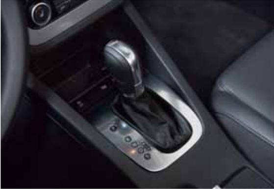
▶ Palanca de cambios, caja automática DSG
