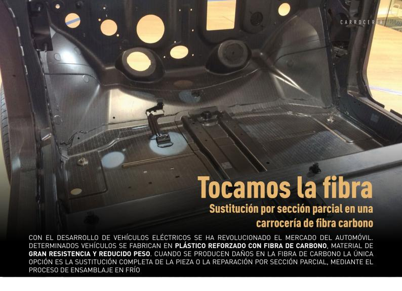
CESVIMAP es pionero en la investigación sobre nuevos materiales. Así que no podíamos dejar de tocar la fibra. La fibra de carbono, CFRP (carbon fiber reinforced polymer). Recogemos un proceso de trabajo sobre un estribo bajo puerta de un BMW i3 REX que presenta daños con perforación y astillamiento; hemos de hacer constar que el fabricante no permite la reparación, pero sí la sustitución por sección parcial.
