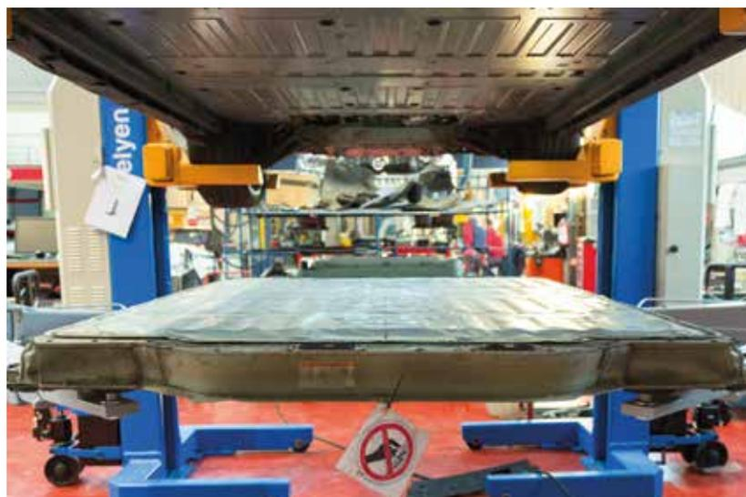
los ocupantes, en caso de impacto, para albergar la batería de alto voltaje de grandes dimensiones (2,5 m x 1,55 m) y sus componentes eléctricos.
