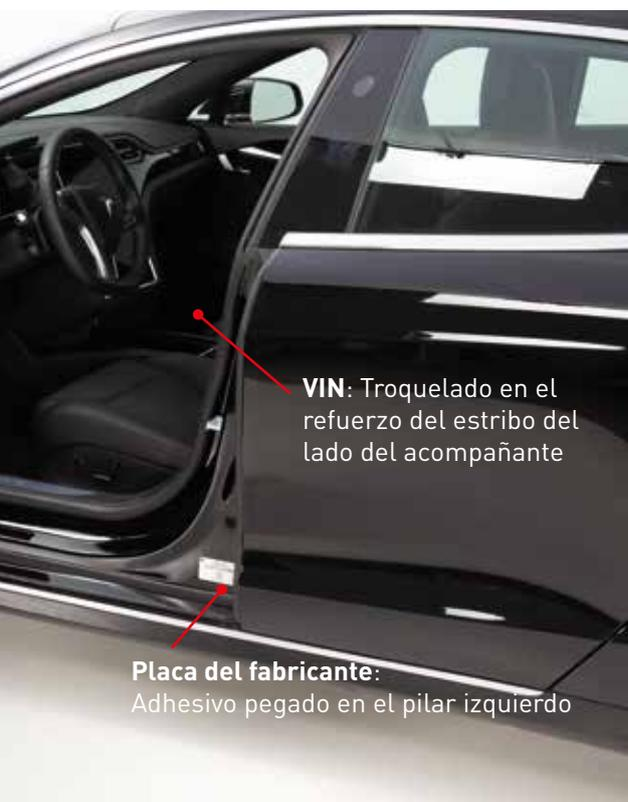
**VIN:** Troquelado en el refuerzo del estribo del lado del acompañante
