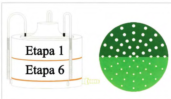
Fig. 1. Esquema del impactador de cascada para partículas viables integrado de dos etapas (Serie 10-800 y marca Tisch Environmental, Inc.).
