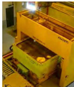
Equipo automático de inyección para bloqueo de bidones en planta de tratamiento NORM en Abu Dhabi.
