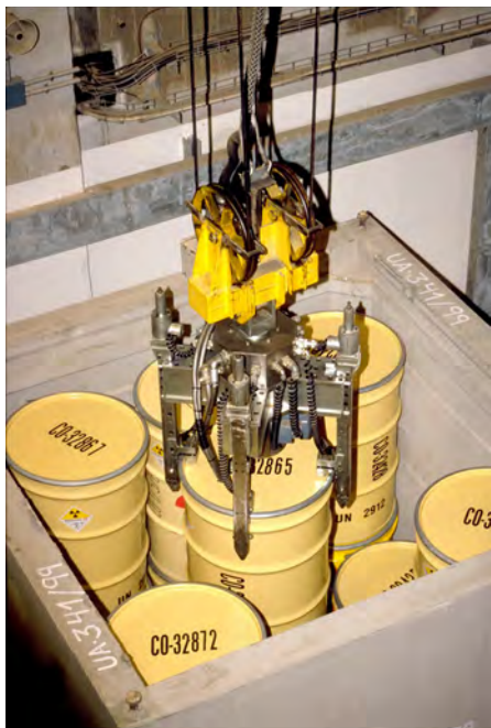
Equipo de manipulación de bidones, El Cabril (ENRESA)
