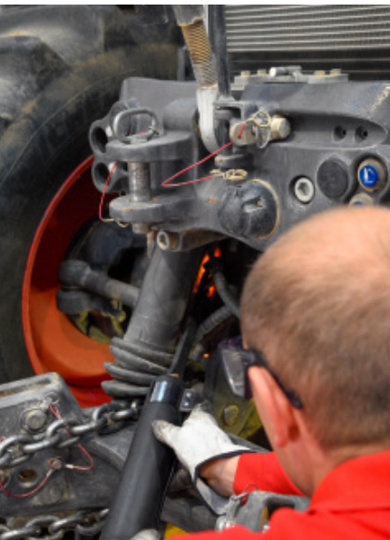
Reparación del chasis de un tractor utilizando calor por inducción
