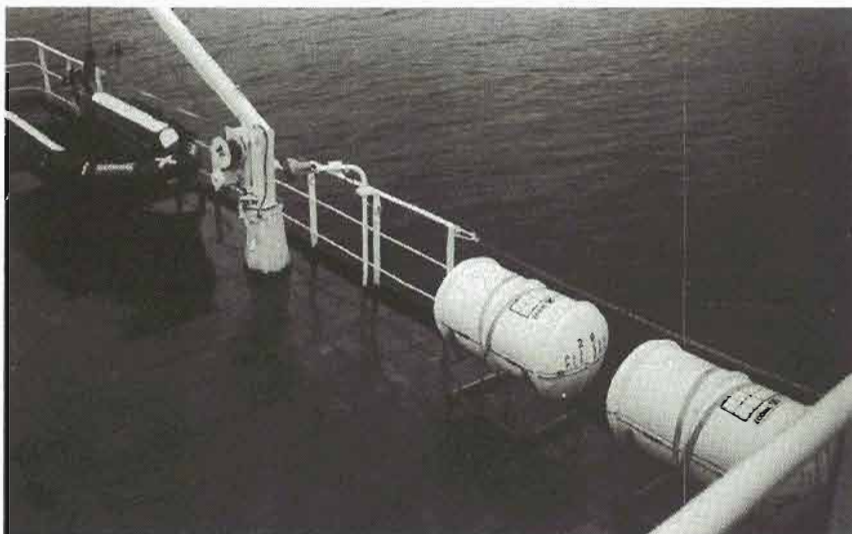
Disposición de balsas en un palangrero. Puestos de estiba y embarque con suficiente espacio libre. Este buque podría haber instalado con facilidad botes salvavidas y pescantes de gravedad.
