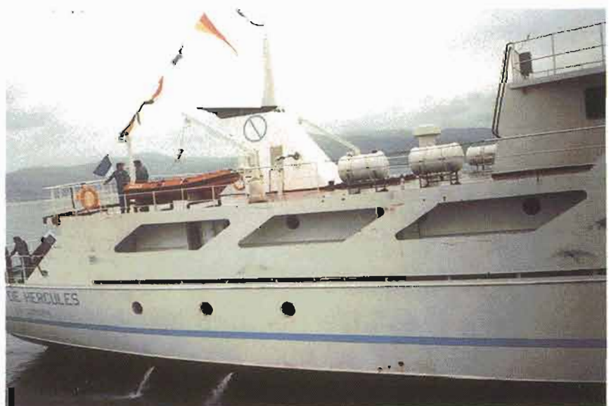
Disposición de botes de rescate y balsas en un moderno palangrero congelador.
