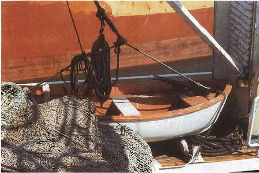
Bote insumergible de un arrastrero congelador. Estiba en el espartel de popa. Interferencias con redes. Acceso comprometido. Calzo de proa roto.
