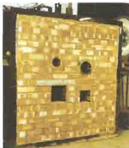
FIGURA 12. Tabique de obra preparado para el ensayo de sellado de penetraciones.
