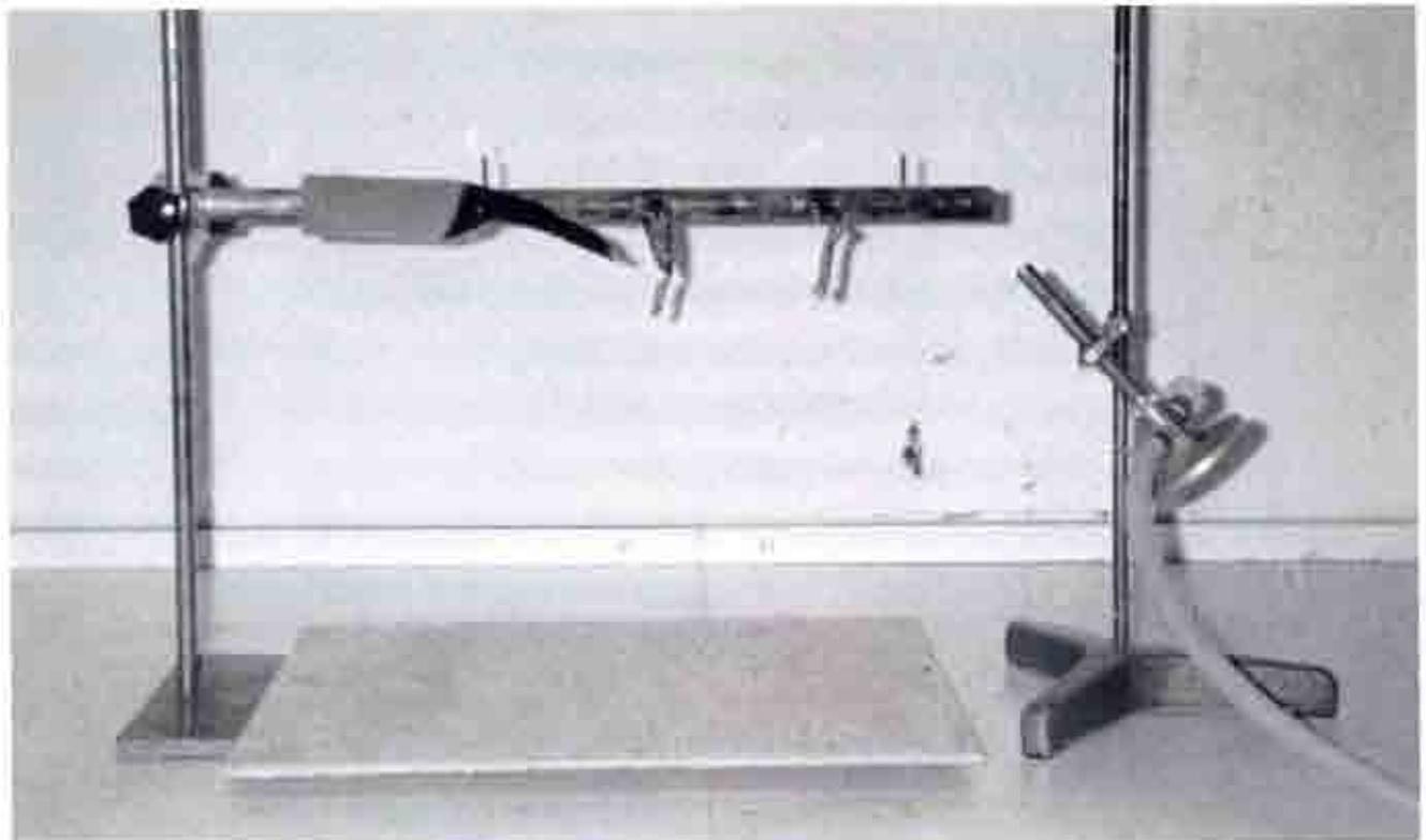
*Medida de la velocidad de propagación de llama en una muestra textil.*
