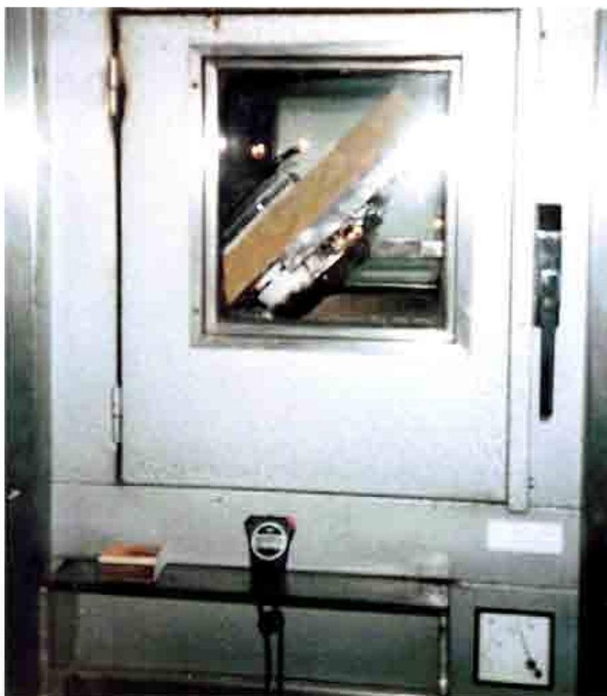
*La muestra es sometida a radiación en el interior del epirradiator.*
