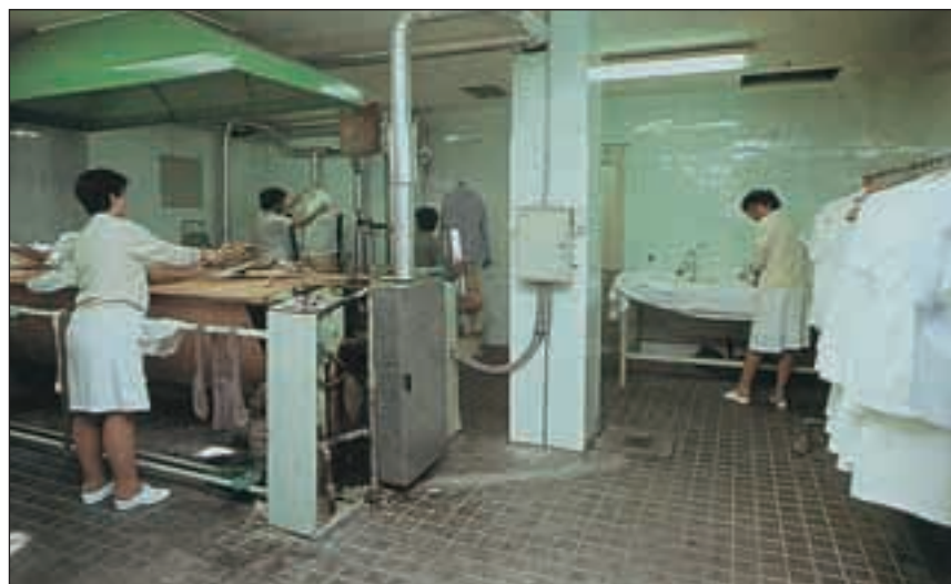
FIGURA 9. Los incendios en lavanderías de hospitales pueden ser atribuidos a menudo a combustiones espontáneas de ropas blancas calientes sacadas de las secadoras y colocadas amontonadas inmediatamente.
