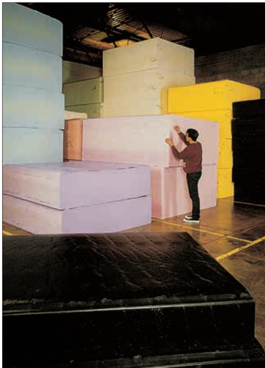
FIGURA 10. El método de obtención habitual de la espuma de poliuretano en grandes bloques provocó en su origen incendios, ya que se almacenaba sin que se hubiera enfriado suficientemente todo el volumen del bloque. Primero porque la reacción isocianato-poliol es fuertemente exotérmica de la reacción y segundo por la propia naturaleza aislante del material.
