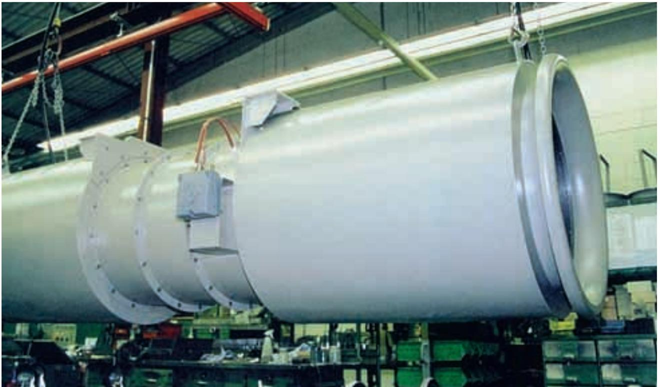
Ventilador de chorro en proceso de fabricación, pintura por electrofóresis con rodete cerrado.
