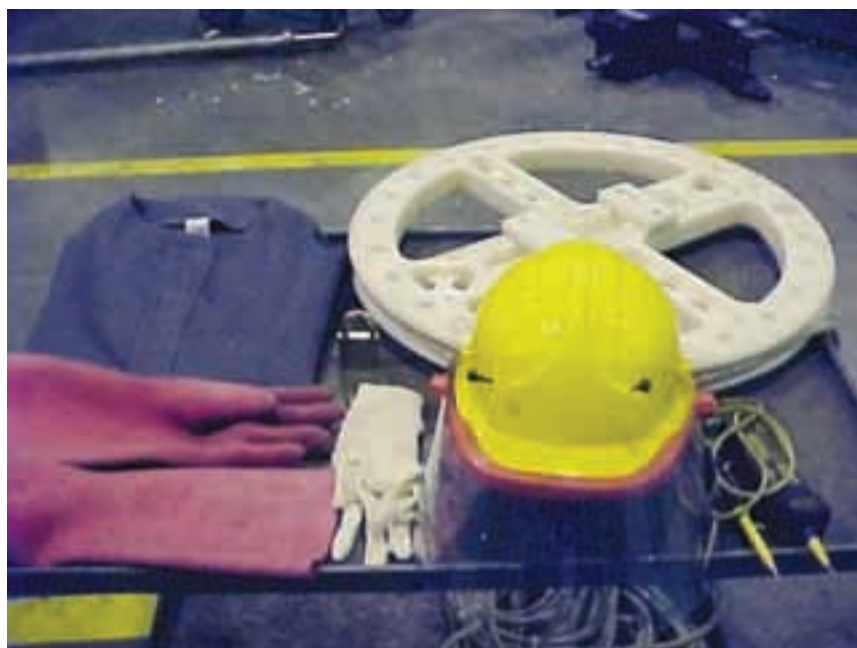
Figura 5. Equipos para la apertura de una caja de derivación con interruptor.
