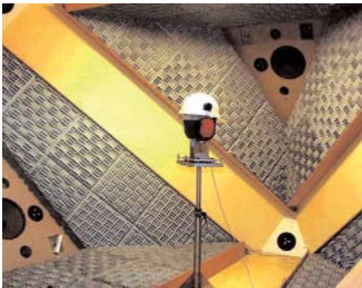
El valor de la atenuación impreso en los protectores acústicos se mide en el laboratorio y puede diferir de las condiciones reales. En la foto, un laboratorio de pruebas del INRS (Francia)
